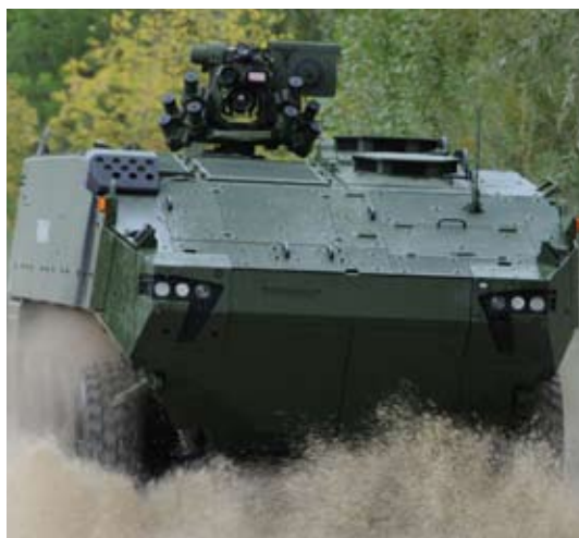
Piranha V fra General Dynamics European Land Systems – Mowag GmbH. Fart: 105 km/t. Vægt: 33 tons. Besætning: 3 + 9 passagerer. Aktionsradius: 1.000 km
